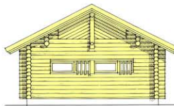
Ikkunat aitan takapäädssä.
